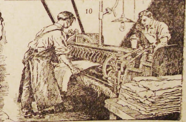
CURTUME: 1. Transporte e manipulação de couros verdes; 2. Descabellamento, e 3. Descarnadura dos couros brutos; 4. Collocação no tanque de lavagem; 5. rrisamento; 6. Divisão d'uma pelle; 7. Lavagem no bombo; 8. Pelle conduzida á machina de desborrar; 9. Lavagem da cal; 10. Descarnadura mechânica.
