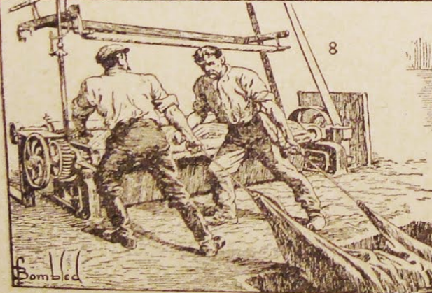
CURTUME: 1. Transporte e manipulação de couros verdes; 2. Descabellamento, e 3. Descarnadura dos couros brutos; 4. Collocação no tanque de lavagem; 5. rrisamento; 6. Divisão d'uma pelle; 7. Lavagem no bombo; 8. Pelle conduzida á machina de desborrar; 9. Lavagem da cal; 10. Descarnadura mechânica.
